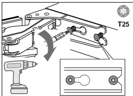
13. Затяните винты. Винты должны быть затянуты с моментом затяжки 6,2 Нм.
