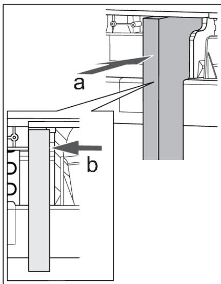
11. Вставьте воздушную перегородку в направлении стрелок а и б.
