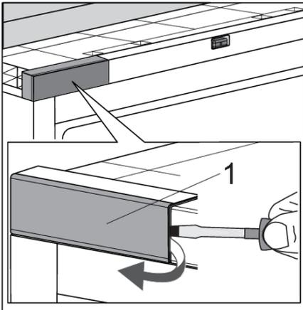
3. Откройте дверь прибора. Аккуратно снимите крышку держателя верхнего шарнира (1) с помощью шлицевой отвертки. Отложите в сторону, так как она понадобится позже. Если вы перенавешивали дверь, сначала прикрутите в верхнем правом углу.
