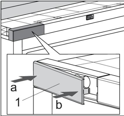
8. Установите на место крышку держателя верхнего шарнира (1). Сначала нажмите в направлении стрелки а, а затем — b.
