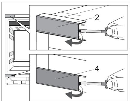
4. Аккуратно снимите крышки держателей верхнего (2) и нижнего (4) шарниров с помощью шлицевой отвертки. Отложите в сторону, так как они понадобятся позже.
