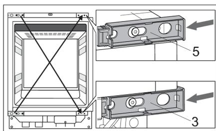
9. Возьмите снятые ранее держатели шарниров (3, 5) и установите на противоположную сторону по диагонали (верхний вниз, нижний вверх).
