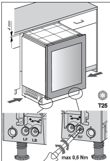
1. Перед тем как задвинуть прибор в нишу, установите высоту прибора на 4 миллиметра меньше высоты проема.
