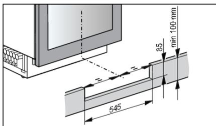
15. Подготовьте кухонный цоколь. Отверстие для вентиляционной решетки в кухонном цоколе должно располагаться по центру прибора. Это единственный способ обеспечить правильную работу прибора.
