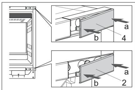
10. Возьмите снятые ранее крышки держателей верхнего (2) и нижнего (4) шарниров и установите на противоположную сторону по диагонали на соответствующий держатель.
